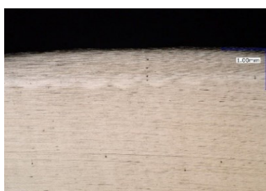
写真④ レーザクリーニング後の溶接断面写真
