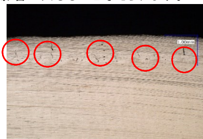
写真③ 通常レーザー照射後の溶接断面写真
