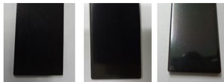
A 黒クロム B 黒色無電解 Ni C 黒クロメート 写真1
